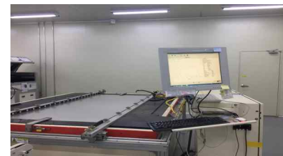
▲ Module 출력 측정 장비
