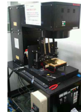
▲ 태양전지 측정장비 및 측정 데이터
